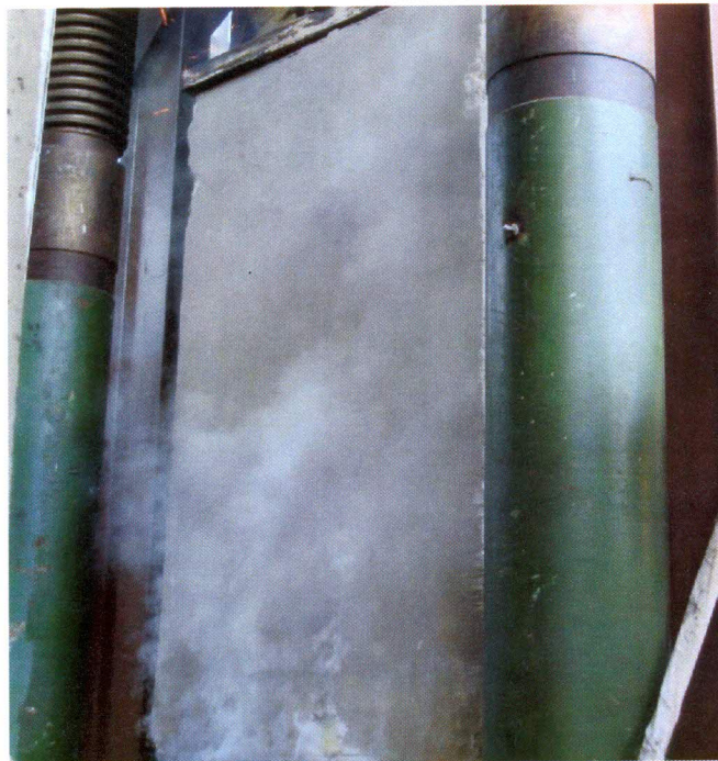
Рис. 4. 35-я мин. испытания, начало дымообразных выделений продуктов термического разложения пенополистирольной несъемной опалубки (опытный образец № 2).
